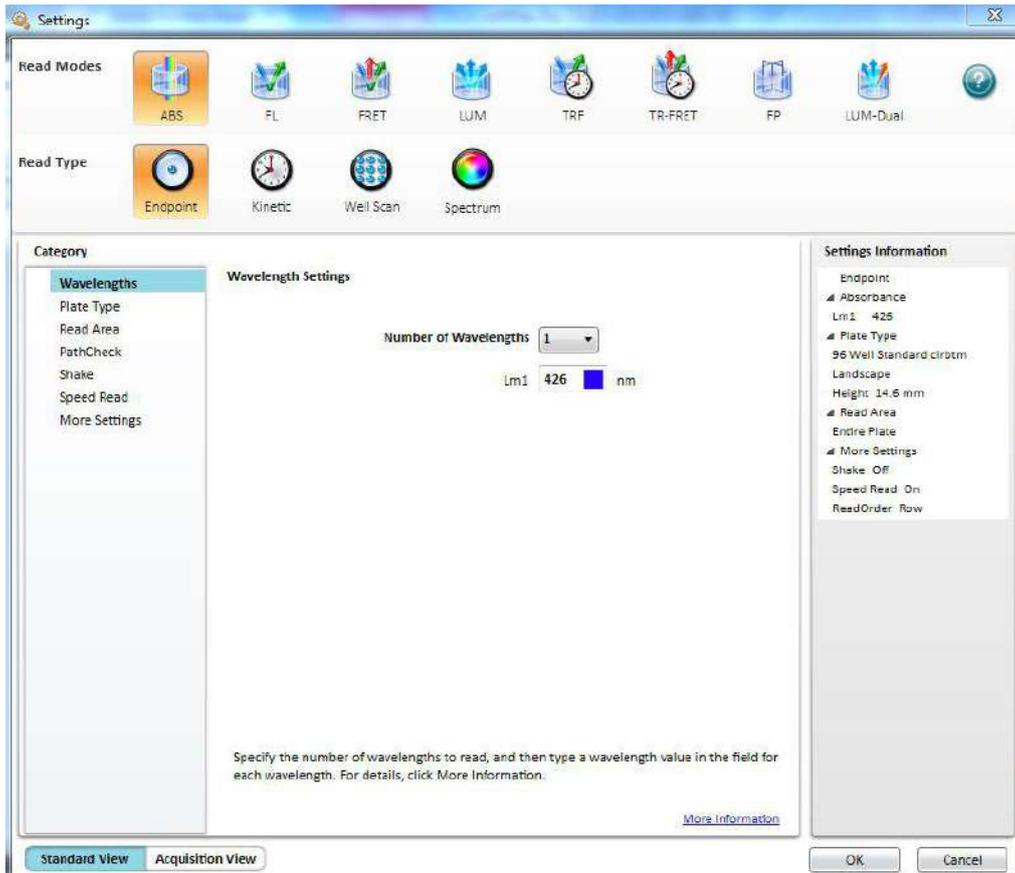
仪器的波长选择根据所选检测功能（Read Modes）分为光栅模式和滤光片模式，除了光吸收功能（ABS）只能使用光栅外，这两种模式在其他功能中既可单独使用也可结合使用（具体情况根据仪器配置而定），检测功能（Read Modes）包括光吸收(ABS)、荧光强度(FL)、荧光共振能量转移（FRET）、化学发光(LUM)、时间分辨荧光（TRF）、时间分辨荧光共振能量转移（TR-FRET）、荧光偏振（FP）和双化学发光（LUM-Dual），如下图所示：
